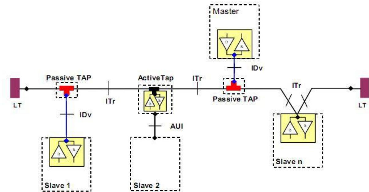
ITr Ein RS485-Modbus<sup>®</sup>, ohne Verstärker besteht aus einem Kabelstrang, an welchen die Geräte direkt angeschlossen werden (Daisy Chain). Der Strang wird auch „Bus“ genannt und kann beliebig lang sein. Seine 2 Enden müssen mit einem Leitungsabschluss versehen werden. Die Benutzung von Verstärkern ist möglich.
